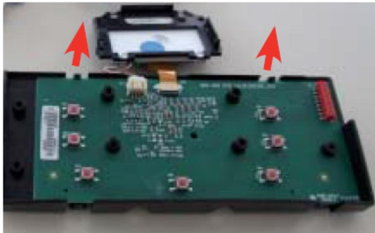
Descontar o conector de alimentação dos led's (Fios verde, branco e vermelho), e o cabo flat da seguinte forma:
