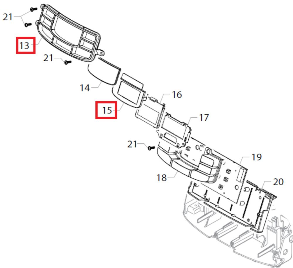
Retirar os dois parafusos torx n°10 indicados com as setas na figura que segue:
