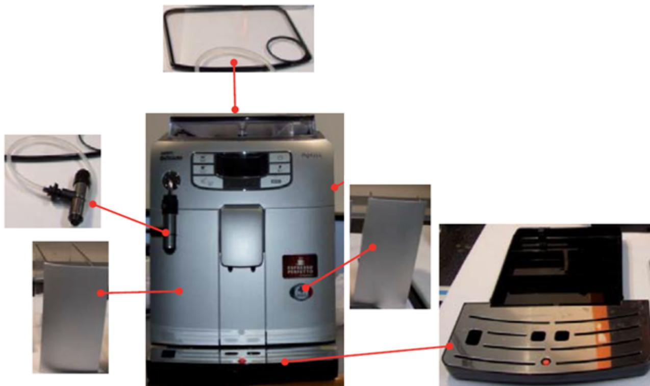
**Remover:** Gaveta de Pingos, Gaveta de Borrax, Reservatório de água, Bico cappuccinador e a Tampa do Reservatório de Café.
