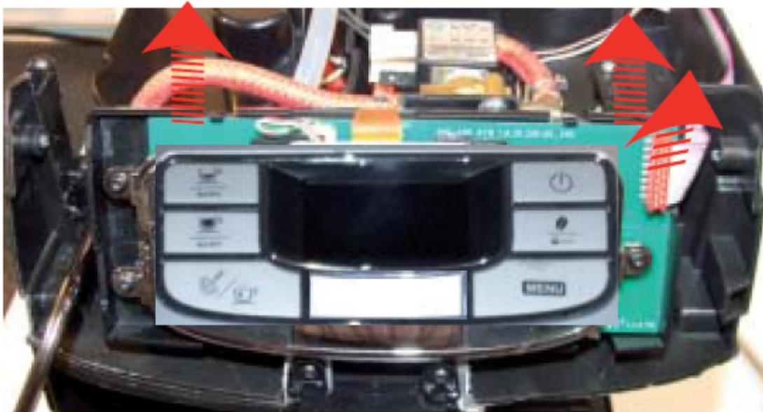
Retirar os três parafusos torx n°10 indicados com as setas na figura que segue:
