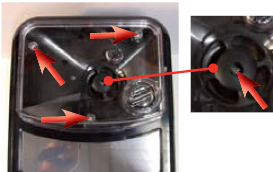
Em seguida remover a tampa de proteção do moinho (parafuso Philips). Após, retirar os três parafusos torx nº10.
